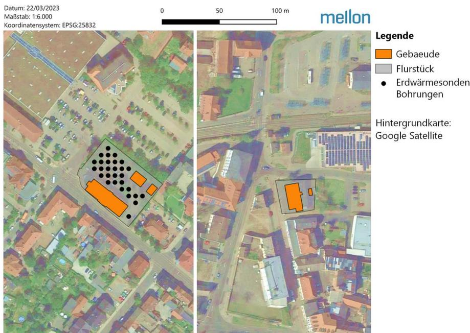
Abbildung 35 Darstellung zur Untersuchung der Erdwärmesondenbohrungen im GIS für die Gebäude der Kreisverwaltung, Gerikestraße 5, Haldensleben (links) und die Musikschule, Halberstädter Straße 1, Oschersleben.
